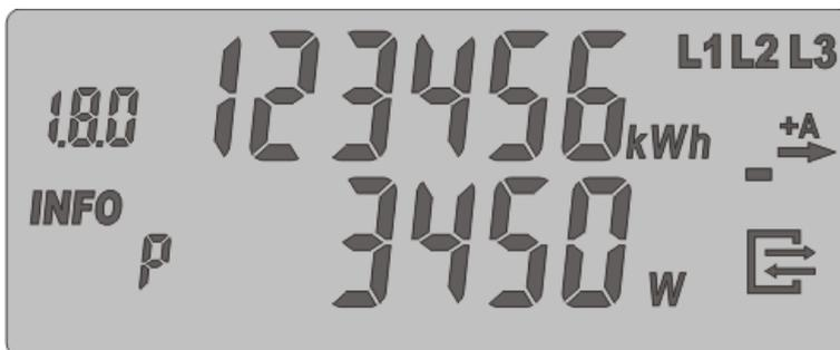
Die Messung der Energie A+, Anzeige des gesamten Wirkenergieflusses erscheinen in der ersten Zeile. In der zweiten Zeile wird die gesamte aktuelle angeschlossene Leistung angezeigt\*. Ganz rechts unten ist die Anzeige der aktiven Kommunikation mit dem Zähler.
