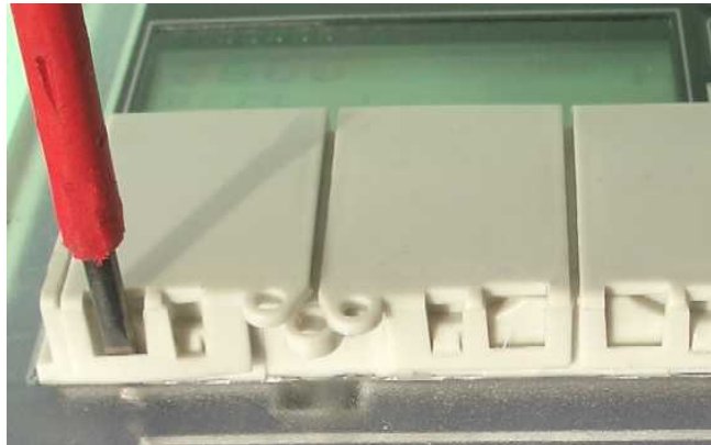
Abbildung 5 Öffnen der Klappen mittels Schraubendreher
