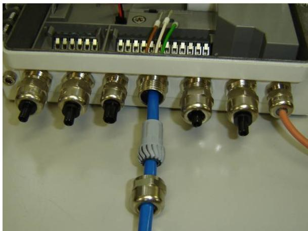
7: Das Kabel in die Kabeldurchführung schieben bis die Abschirmung in der Kabeldurchführung sitzt
