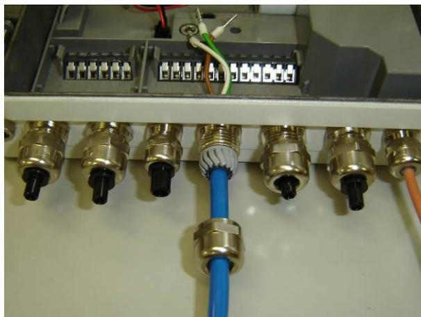
8: Die Abdichthülse in die Kabeldurchführung schieben und diese leicht festziehen
